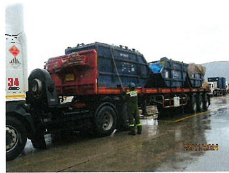
รูปที่ 2-3 การผูก/มัดวัสดุอุปกรณ์รถบรรทุก
